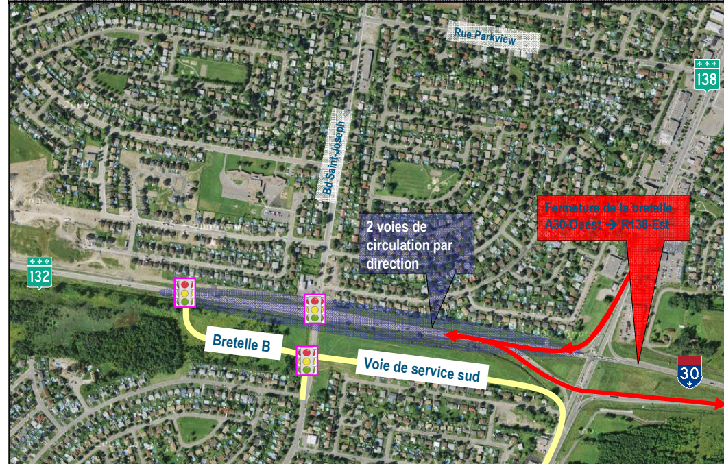
2-Schéma de principe autour de l'échangeur R-132 / R-138 / A-30
